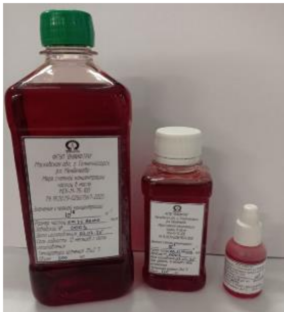
Рисунок 1 – Общий вид мер счетной концентрации частиц в масле МСК-М-75-100
