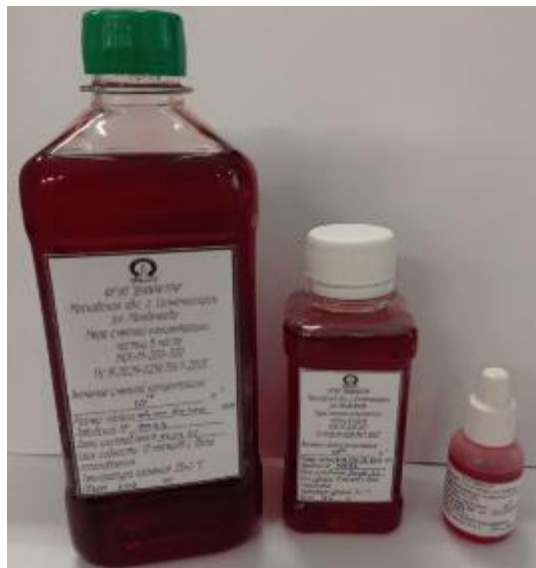
Рисунок 1 – Общий вид мер счетной концентрации частиц в масле МСК-М-200-300
