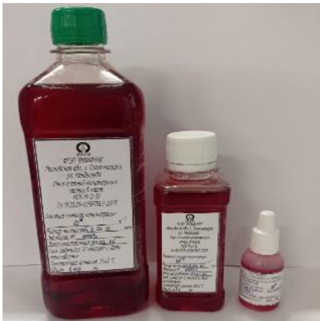
Рисунок 1 – Общий вид мер счетной концентрации частиц в масле МСК-М-2-10
