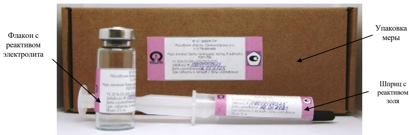
Рисунок 1 – Общий вид комплекта поставки мер значения дзета-потенциала частиц в жидкости МДП-П90
