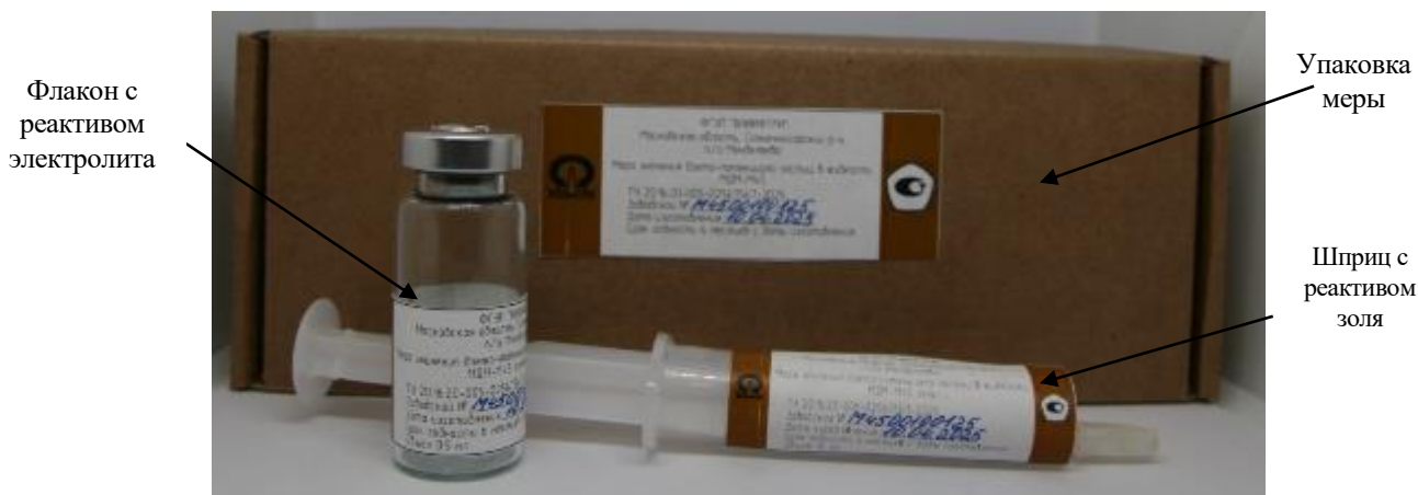
Рисунок 1 – Общий вид комплекта поставки мер значения дзета-потенциала частиц в жидкости МДП-М45
