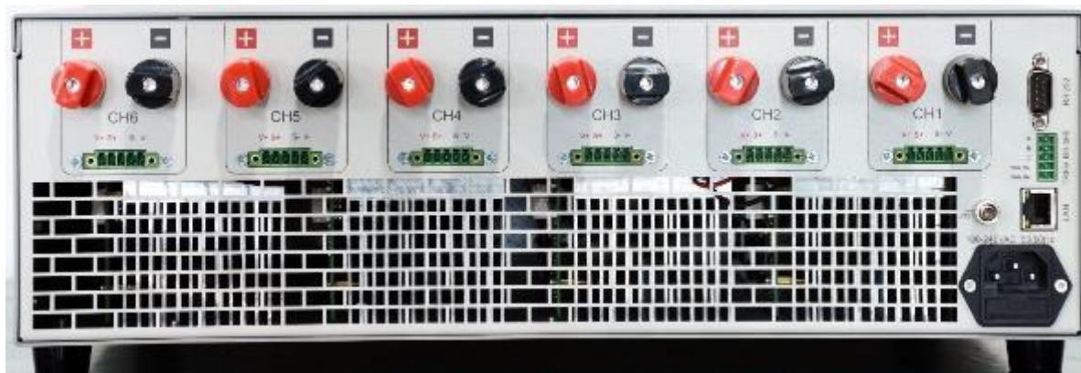
Рисунок 4 – Вид задней панели нагрузок модификации АКІП-1389-6К-80-40, АКІП-1389-6К-150-40, АКІП-1389-6К-600-10
