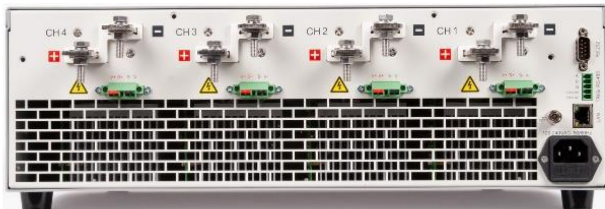
Рисунок 5 – Вид задней панели нагрузок модификации АКПП-1389-4К-80-60, АКПП-1389-4К-150-60, АКПП-1389-4К-600-15
