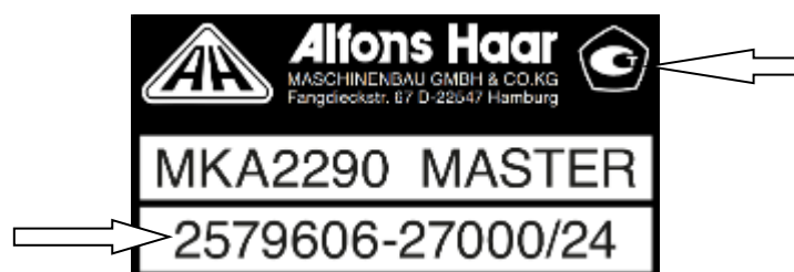
Рисунок 3 – Обозначения мест нанесения знака утверждения типа и заводского номера на маркировочной табличке
