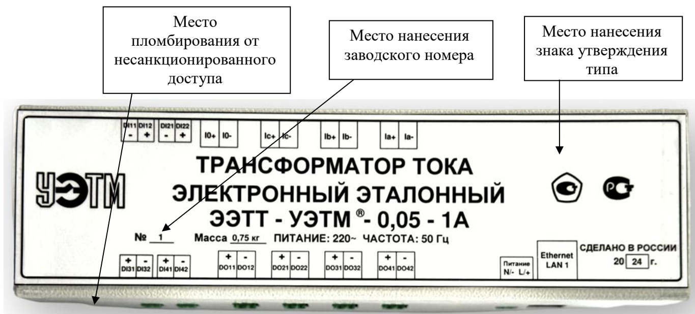
Рисунок 1 – Общий вид трансформатора тока электронного эталонного ЭЭТТ-УЭТМ®-0,05-1А с указанием мест пломбирования от несанкционированного доступа, мест нанесения знака утверждения типа, мест нанесения заводского номера
