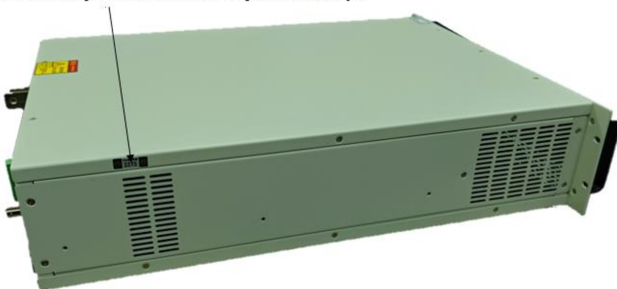
Рисунок 2 – Схема пломбировки от несанкционированного доступа
