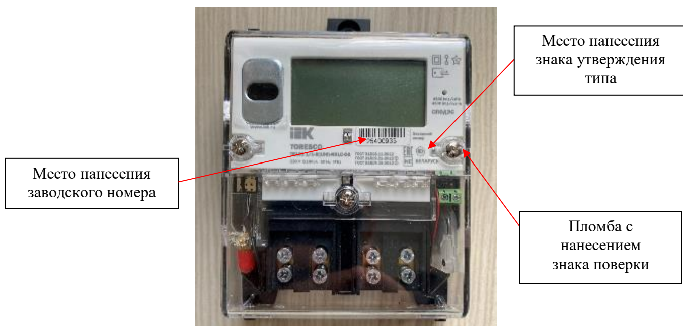
Рисунок 2 – Общий вид однофазных счетчиков исполнения с индексом ТЕ101 в коде с указанием места ограничения доступа к местам настройки (регулировки), места нанесения знака утверждения типа, места нанесения заводского номера
