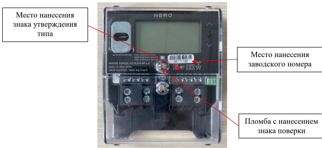
Рисунок 2 – Общий вид однофазных счетчиков исполнения с индексом SM205 в коде с указанием места ограничения доступа к местам настройки (регулировки), места нанесения знака утверждения типа, места нанесения заводского номера
