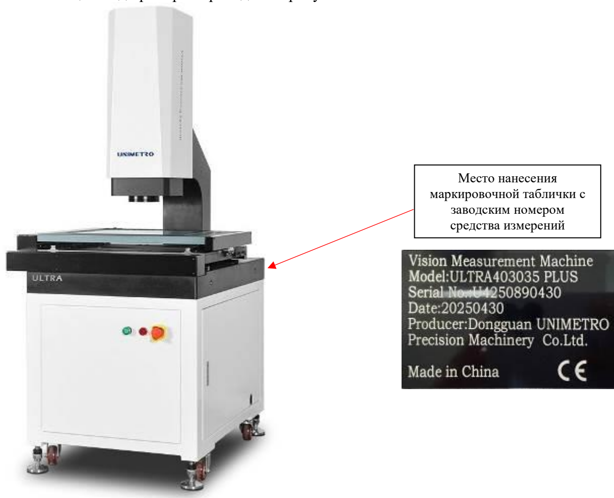
Рисунок 1 – Общий вид микроскопов видеоизмерительных консольных UNIMETRO ULTRA
