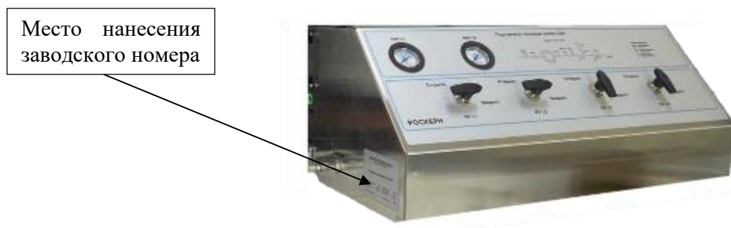
Рисунок 2 – Место нанесения заводского номера на порозиметры гелиевые СКИФ-ПЗМ
