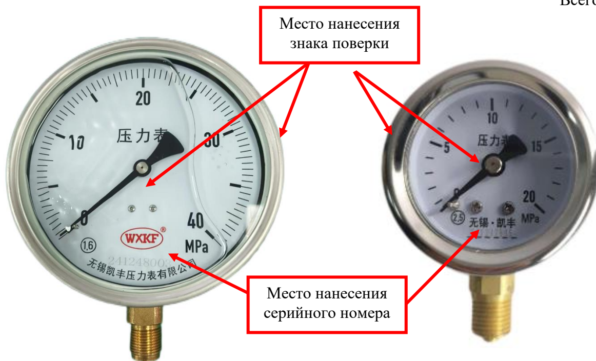
Рисунок 7 – Общий вид манометров, место нанесения серийного номера и места нанесения знака поверки
