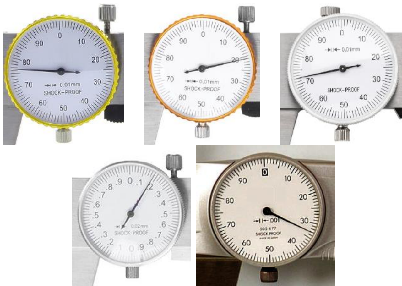
Рисунок 8 – Общий вид круговой шкалы отсчетного устройства штангенциркулей
