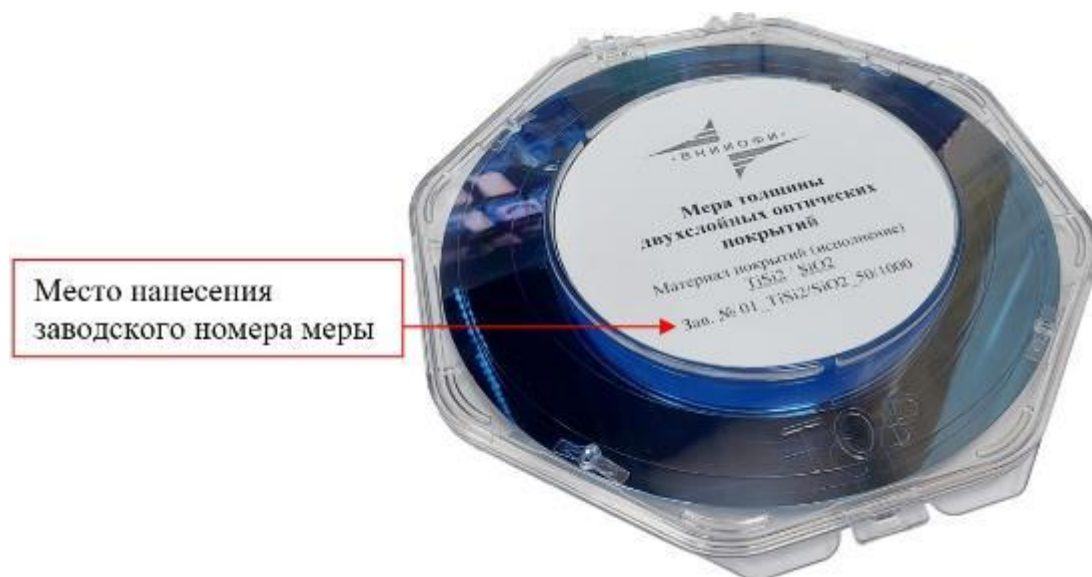
Рисунок 1 – Общий вид индивидуального герметичного пластикового контейнера с мерой толщины двухслойных оптических покрытий
