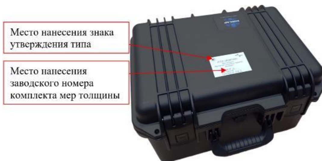
Рисунок 1 – Общий вид индивидуального герметичного пластикового контейнера с мерой толщины двухслойных оптических покрытий
