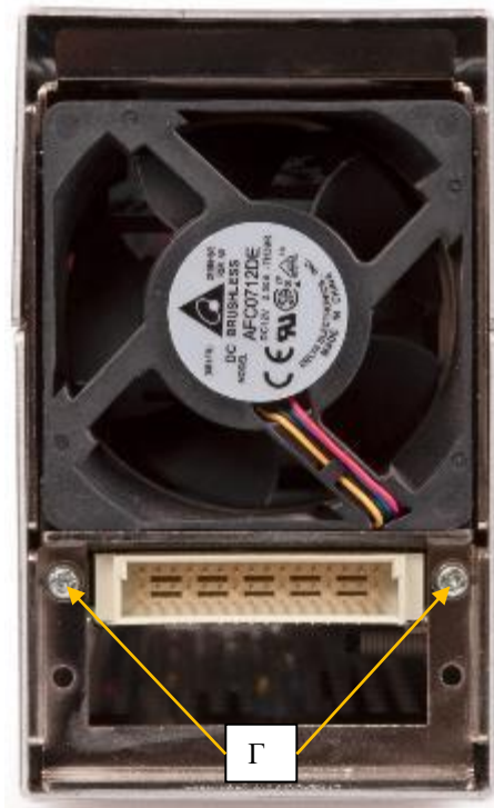
Рисунок 3 – Вид задней панели с местами пломбировки корпуса нагрузки (Г)
