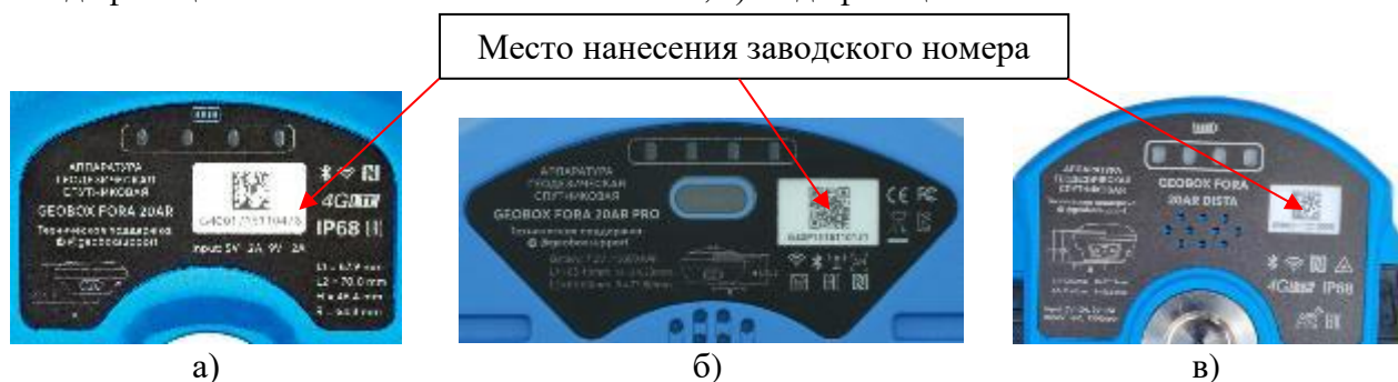
Рисунок 2 – Общий вид аппаратуры геодезической спутниковой GEOBOX FORA: а) модификация GEOBOX FORA 20H; б) модификация GEOBOX FORA 20SE; в) модификация GEOBOX FORA SMART PRO; г) модификация GEOBOX FORA LUX IMU
