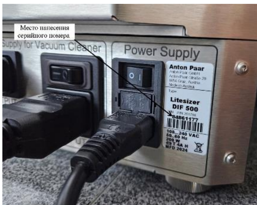
Рисунок 2 – Общий вид маркировочной таблички и место нанесения серийного номера
