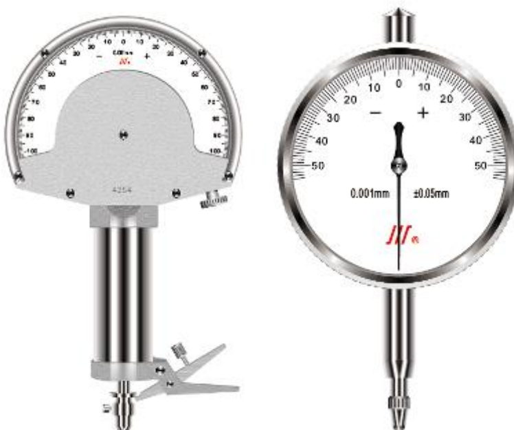
Рисунок 6 – Общий вид индикаторов модели ИЧ с ценой деления 0,001 мм, с малым диапазоном измерений
