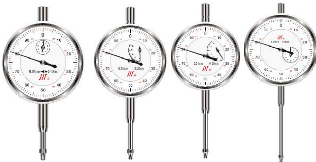
Рисунок 2 – Общий вид индикаторов модели ИЧ с ценой деления 0,01 мм, многооборотные
