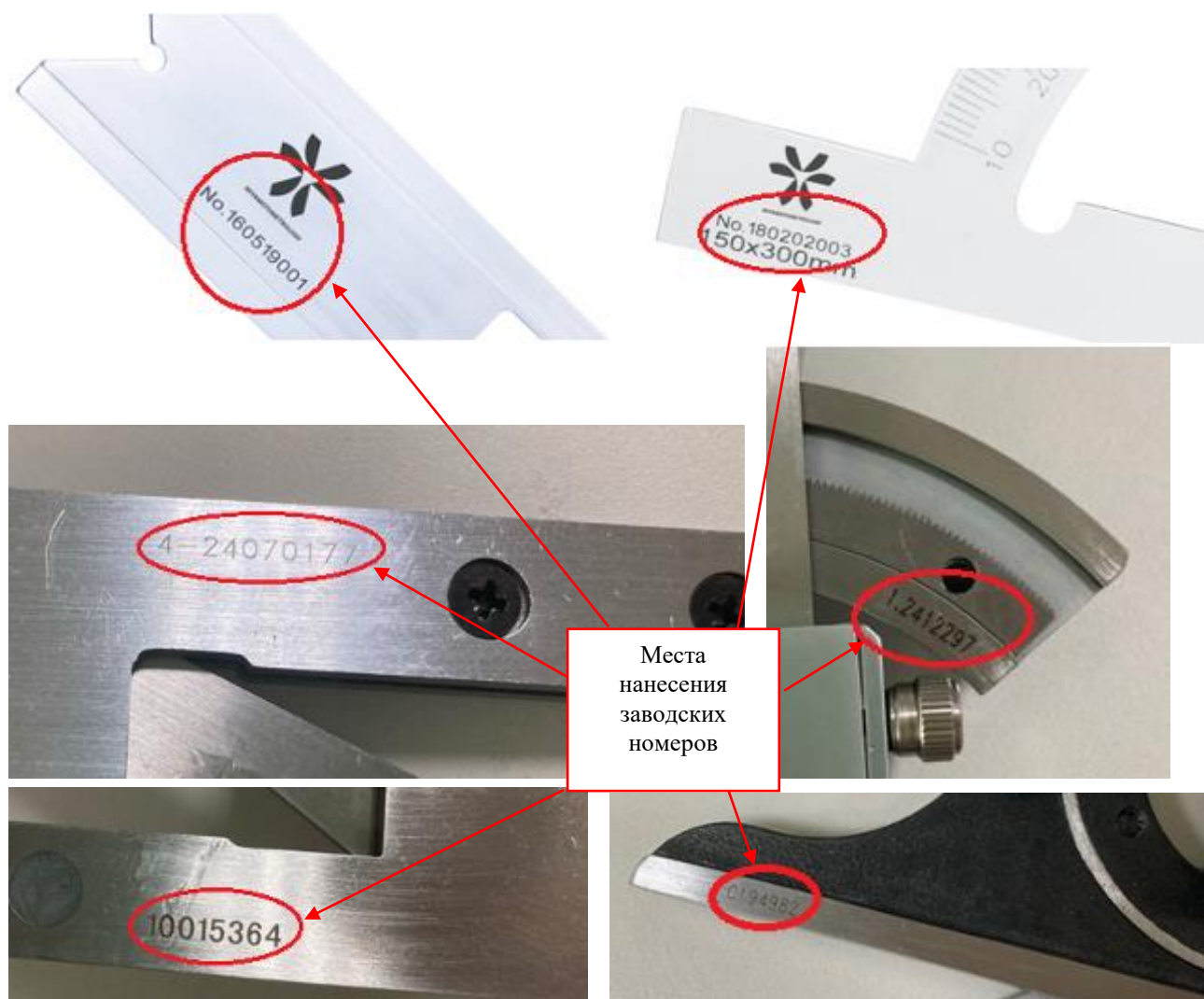
Рисунок 15 – Места нанесения заводского номера
