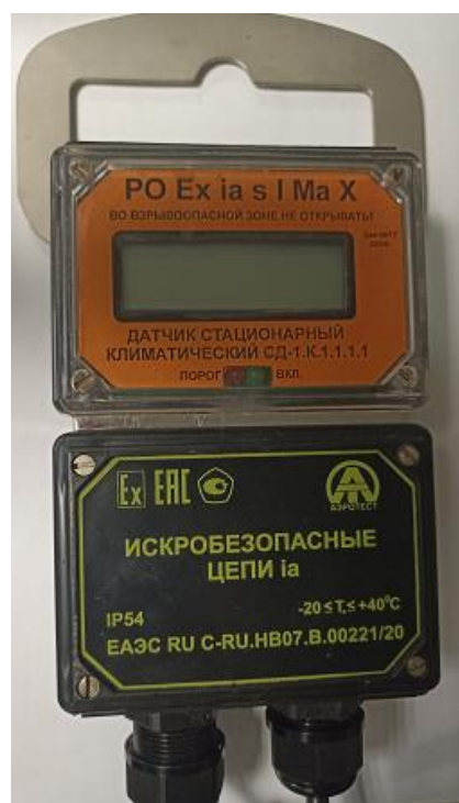
г) датчик стационарный климатический СД-1.К.1
