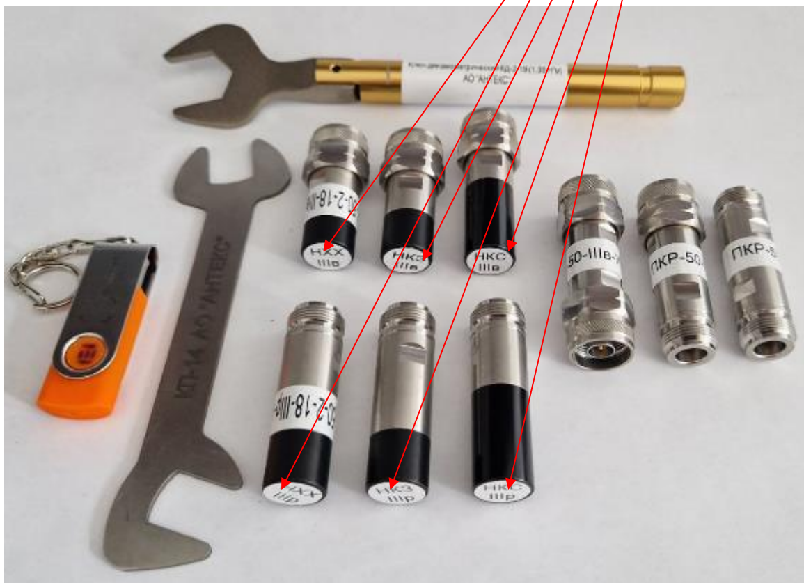
Рисунок 3 – Внешний вид наборов нагрузок калибровочных ННК в модификациях ННК-18-III тип III коаксиального соединителя и ННК-18-N тип N коаксиального соединителя с обозначением места пломбировки
