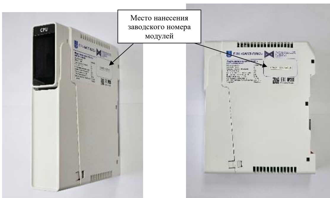
Рисунок 3 – Обозначение места нанесения заводского номера модулей
