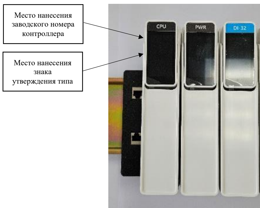
Рисунок 2 – Обозначение места нанесения заводского номера и знака утверждения типа контроллера
