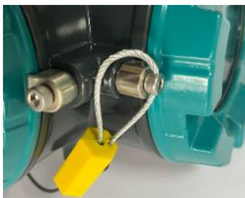
Рисунок 2 – Места пломбирования корпуса уровнемера
