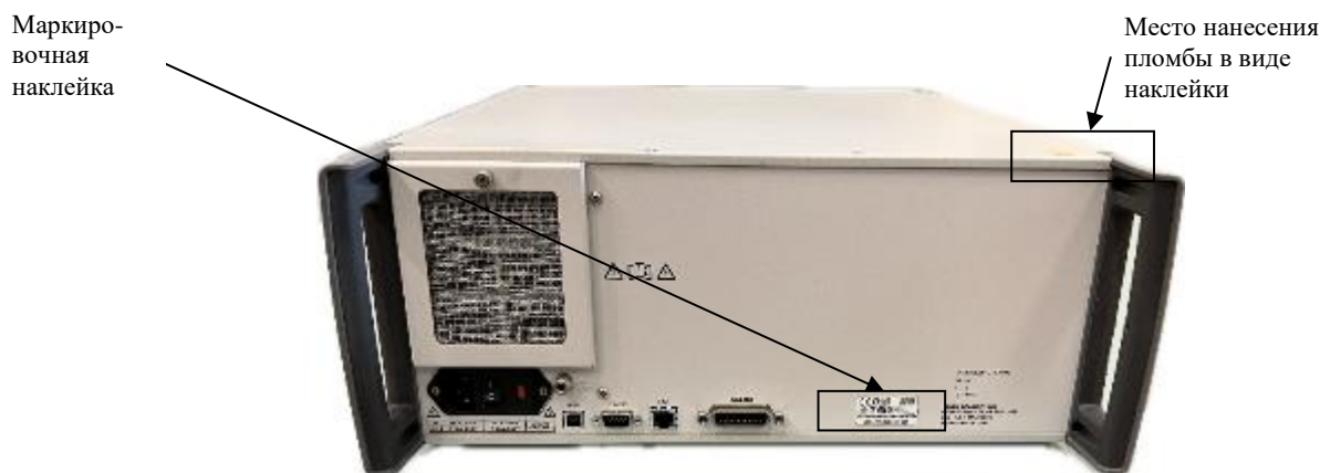
Рисунок 2 – Схема пломбировки от несанкционированного доступа, место нанесения маркировочной наклейки
