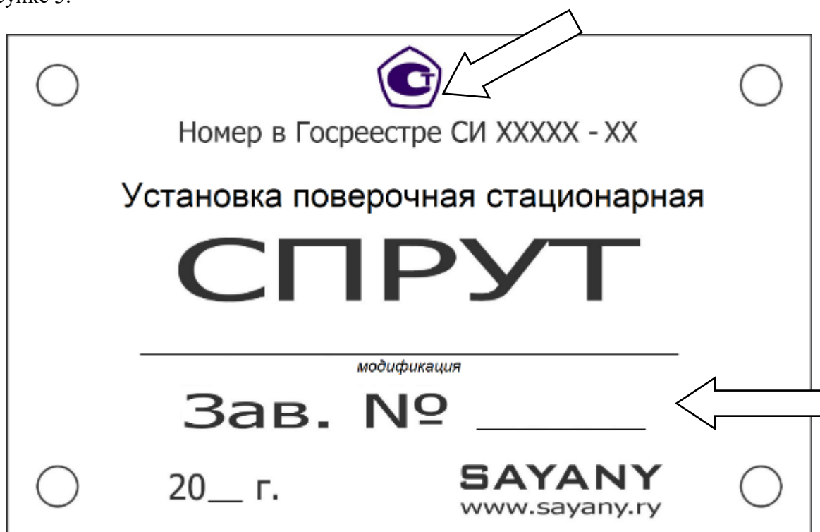
Рисунок 3 – Обозначения мест нанесения знака утверждения типа и заводского номера
