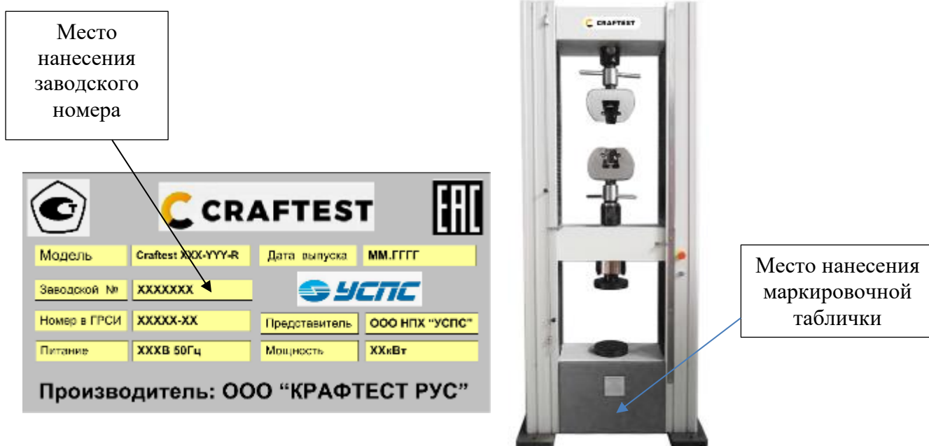
Рисунок 2 – Место расположения маркировочной таблички и нанесения заводского номера
