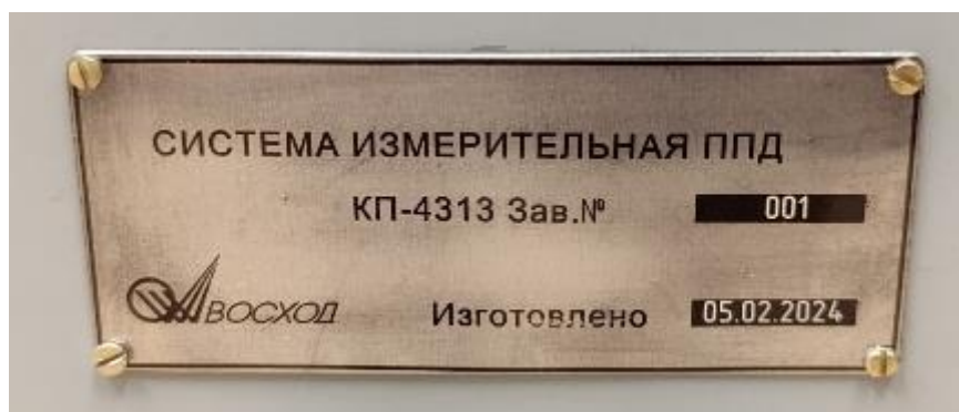
Рисунок 3 – Табличка-шильдик с маркировкой, заводским номером
