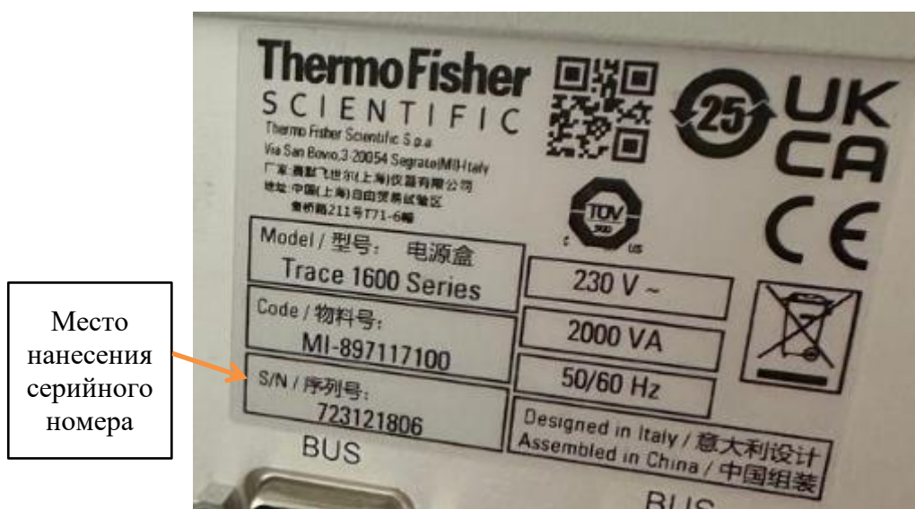
Рисунок 3 – Информационная табличка хроматографа (шильд)
