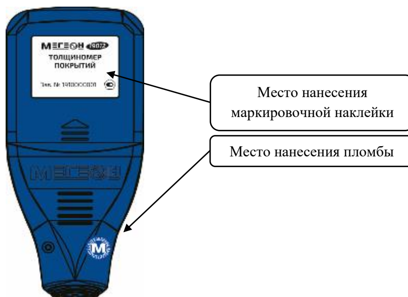
Рисунок 3 – Место нанесения маркировочной наклейки и пломбы
