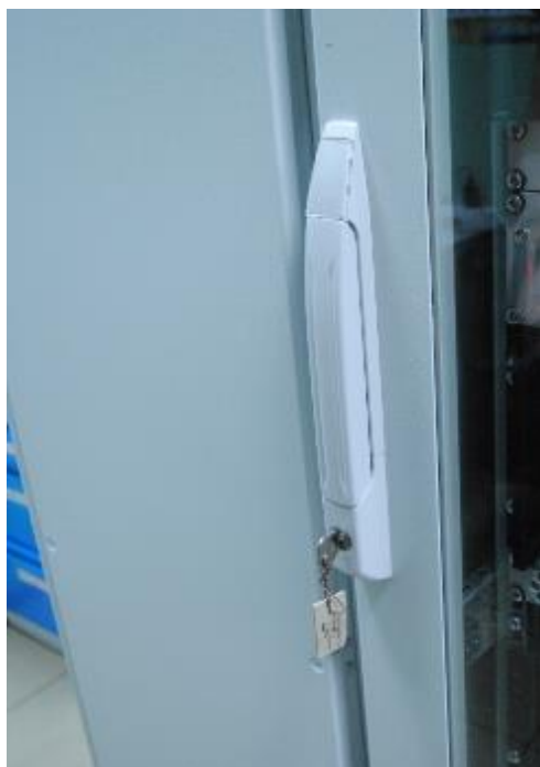
Рисунок 4 – Запирающий механизм шкафа приборного
