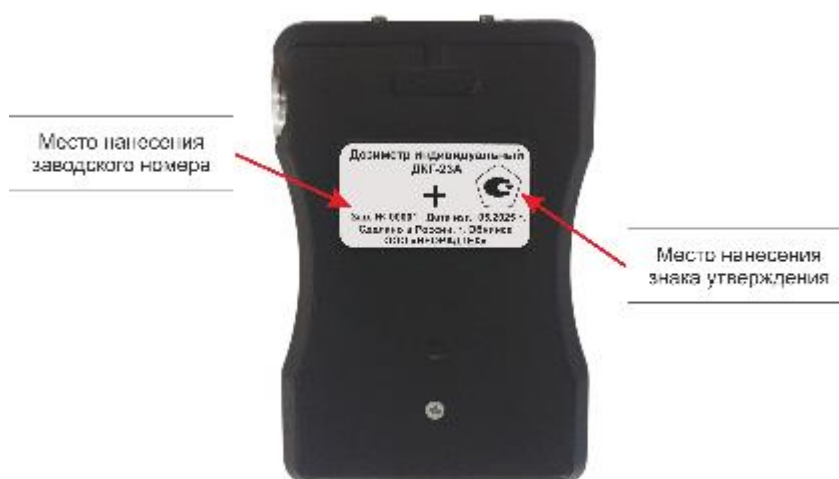
Рисунок 2 – Место нанесения знака утверждения и заводского номера на ДКГ-23А
