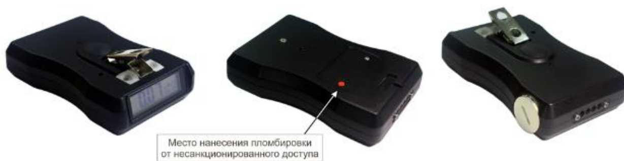
Рисунок 1 – Общий вид ДКГ-23А с указанием места нанесения пломбировки от несанкционированного доступа
