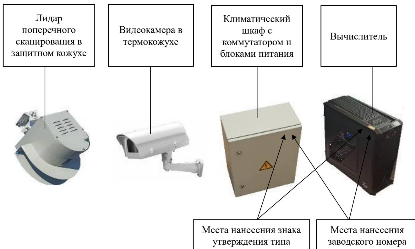
Рисунок 3 – Общий вид элементов, входящих в состав ПАУК-ПНГ, с указанием места нанесения знака утверждения типа, места нанесения заводского номера
