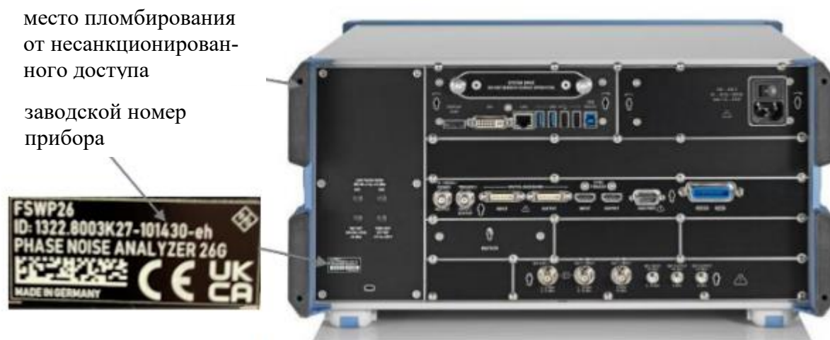
Рисунок 2 – Вид задней панели анализатора. Схема пломбировки от несанкционированного доступа и размещения наклейки с номером прибора
