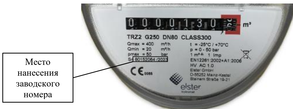
Рисунок 2 – Общий вид информационной таблички счетчиков TRZ2 с указанием места нанесения заводского номера
