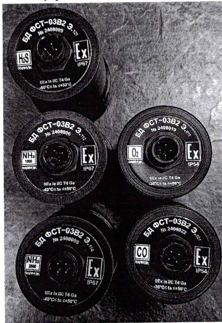
Рисунок 1.1 – Фотографии общего вида и маркировки БД ФСТ-03В2 Э (изображение носит иллюстративный характер)
