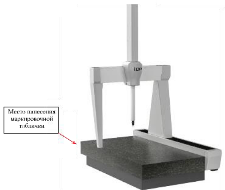
Рисунок 2 – Общий вид КИМ модификации IDP MCC
