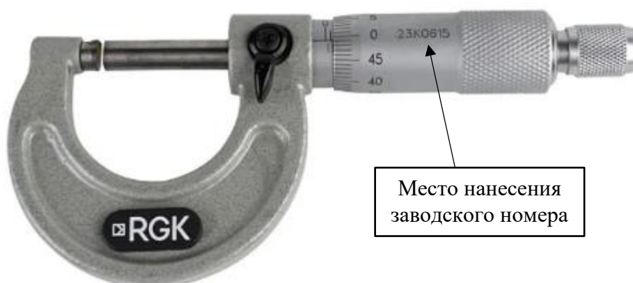
Рисунок 2 – Общий вид микрометров модификаций МРМ-25 с указанием места нанесения заводского номера
