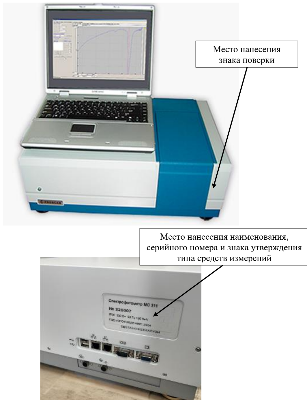
Рисунок 1 – Общий вид и схема маркировки спектрофотометра
