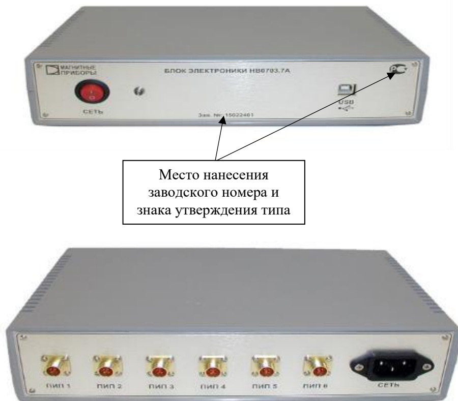
Рисунок 3 – Общий вид блока электроники НВ0703.7А с указанием мест нанесения знака утверждения типа и заводского номера
