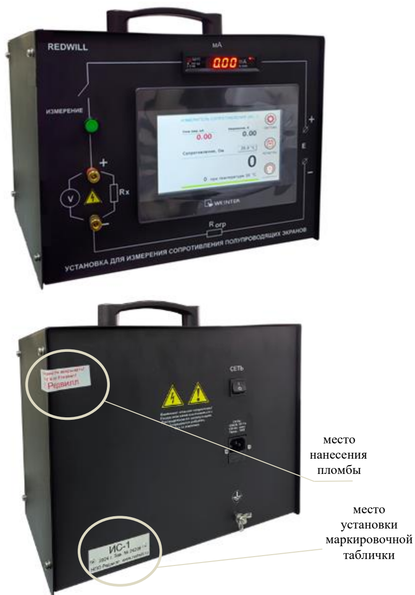
Рисунок 1 – Общий вид измерителей, места установки маркировочной таблички и пломбировки от несанкционированного доступа
