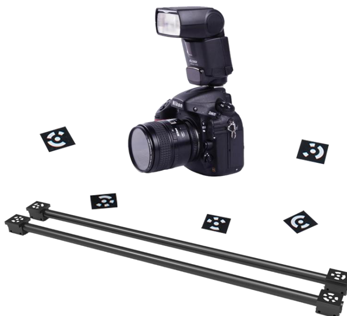
Рисунок 3 – Общий вид фотограмметрической системы CoordMeasis
