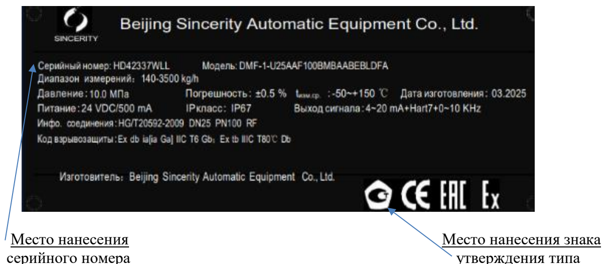
Рисунок 3 – Место нанесения знака утверждения типа и серийного номера
