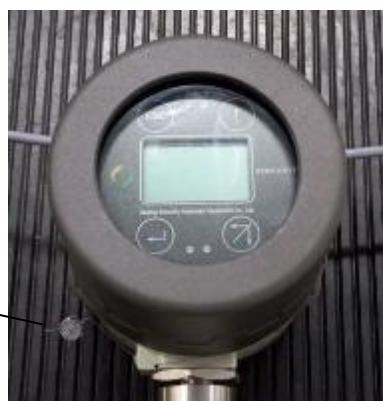
Рисунок 2 – Схема пломбировки от несанкционированного доступа
