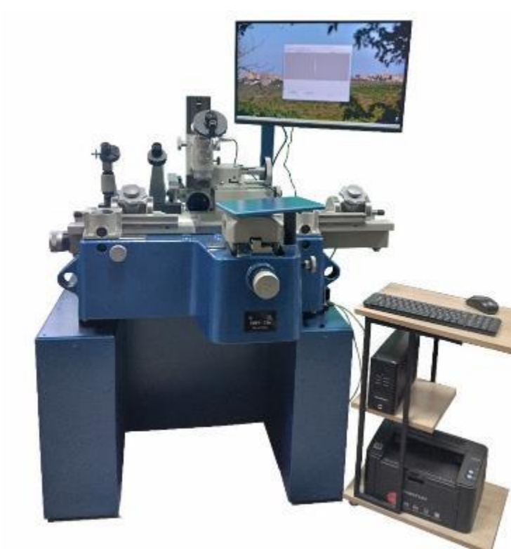
Рисунок 1 – Общий вид микроскопов модификации УИМ-21м
