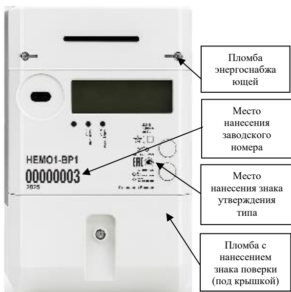
Рисунок 4 – Общий вид счетчиков в корпусе В с указанием места нанесения заводского номера, знака утверждения типа, места ограничения доступа к местам настройки (регулировки)
