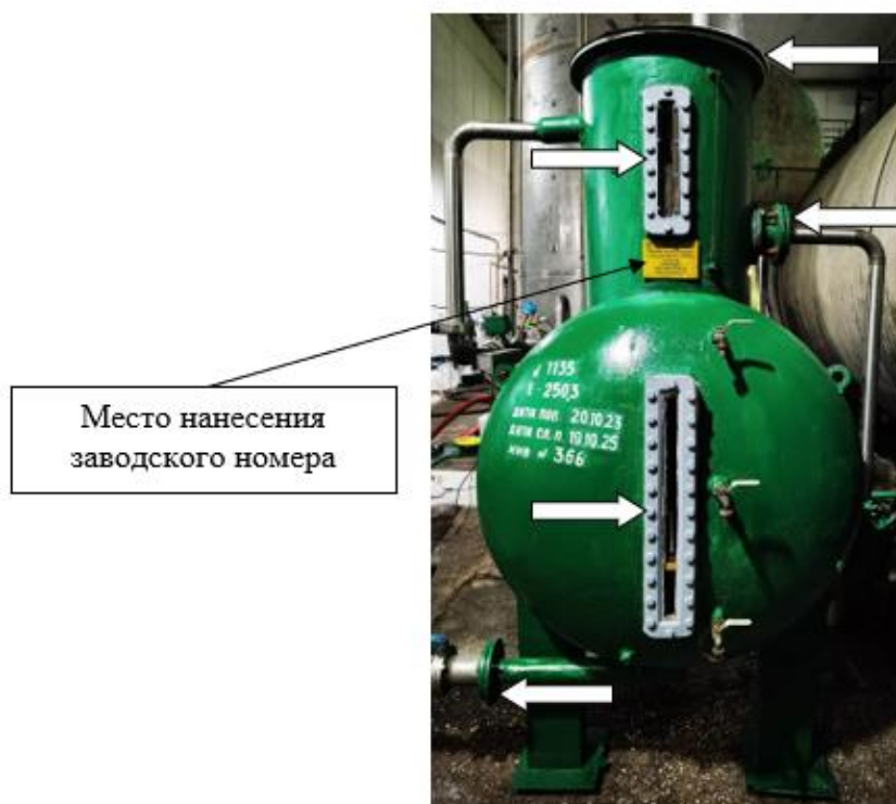
Рисунок 1 – Общий вид мерника металлического технического 1-го класса Г4-ВИЦ-250 и схема пломбировки от несанкционированного доступа, обозначение места нанесения знака поверки и место нанесения заводского номера
