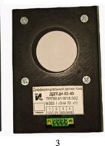
Рисунок 1 – Общий вид СКИ, где 1 – БКУ, 2 – ДДТЦИ-02-90, 3 – ДДТЦИ-02-40, 4 – ДДТЦИ-02-20
