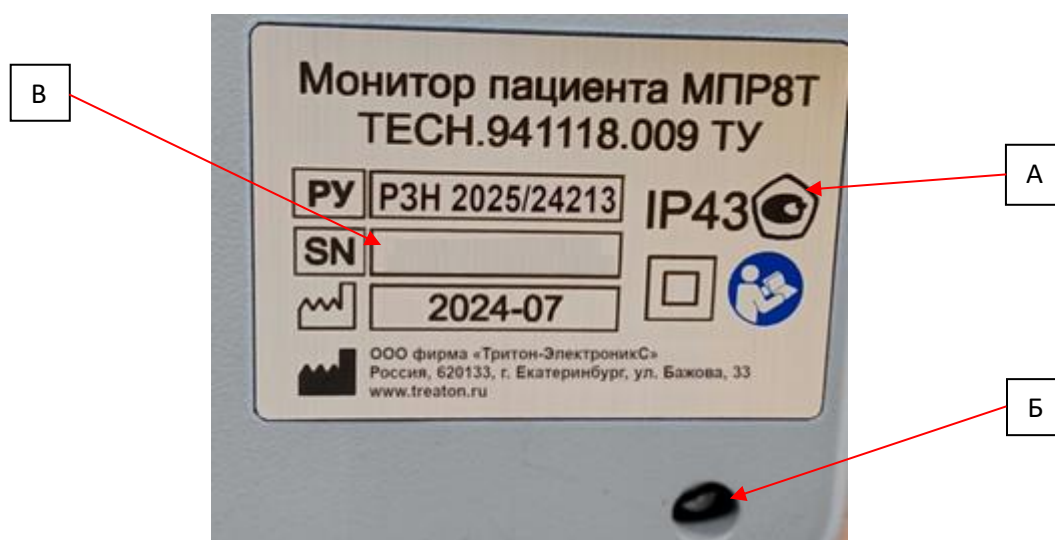
Рисунок 2 – Место нанесения знака утверждения типа (А), место пломбировки от несанкционированного доступа (Б) и место нанесения серийного номера (В)
