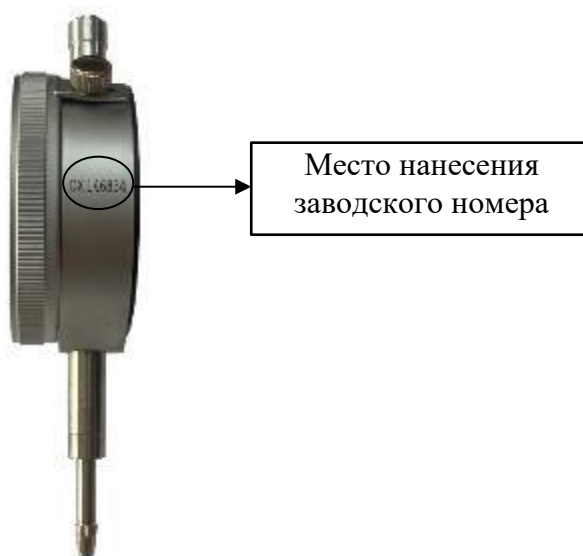
Рисунок 2 – Место нанесения заводского номера на отсчетное устройство
